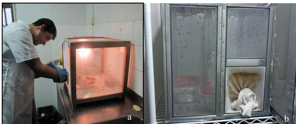
Figura 8 – Gaiola entomológica para a criação de C. albiceps (a), nos experimentos realizados no Brasil. e C. megacephala (b). nos experimentos realizados nos EUA.
