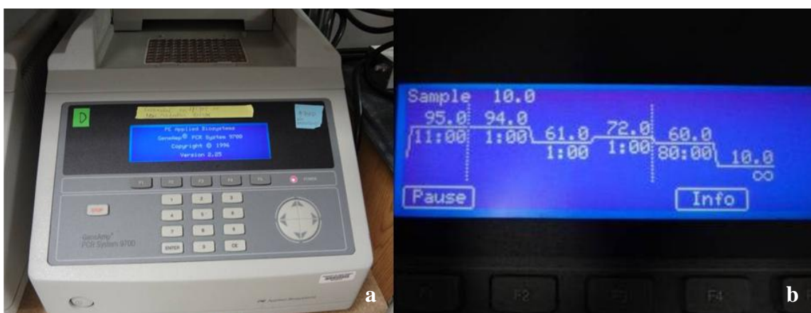
Figura 18 – Termociclador GeneAmp PCR System 9700® (a) e programação térmica para Y-filer (b)
